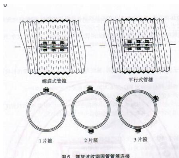
图6 螺旋波纹钢管管箍连接
